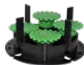
Stelzlager, Vollstück, höhenverstellbar von 35–50 mm, ergibt 3 mm breite Fugen. Rand- und Eckstücke können herausgebrochen, bzw. geschnitten werden.
