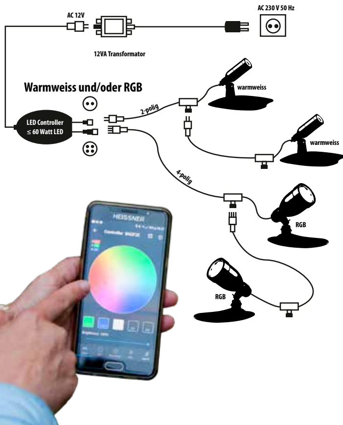
WiFi-LED-Controller - Für RGB und warmweiss Licht-Steuerung per APP
